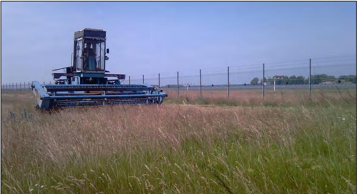
**Abbildung 3-7: Schwadmäher im Betrieb (LEGUAN GMBH 2016c)**
