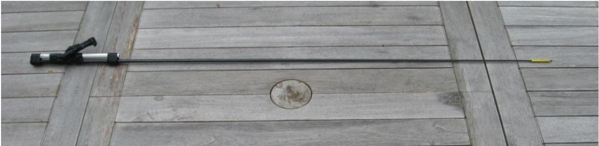
**Abbildung 2-4: Fangschlinge Gesamtansicht**
