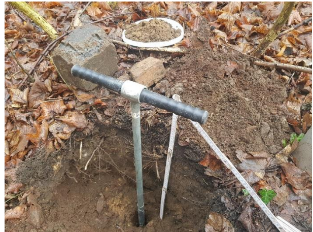
Bild 4: Schurf 2, 0,5 m Sand, Schutt, Schlacke, im Liegenden heller Sand
