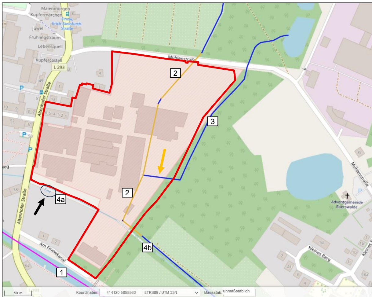
Abb. 21: Verlauf von Finow, Lichterfelder- und Walzwerkgraben im Untersuchungsgebiet als vom Wasser- und Bodenverband Finowfließ (WBV) bewirtschaftete Gräben I. und II. Ordnung. Lila: I.O., offen; blau: II.O., offen; orange: II.O., verrohrt, oranger Pfeil: Abschnitt ebenfalls verrohrt, Verlauf unkorrekt gezeichnet. Schwarzer Pfeil: Bezeichnung „Fine“. Parameter siehe Tab. 7, Quelle: Wasser- und Bodenverband Finowfließ – Kartenanwendung 2025, veränd., © WBV, https://www.wbv-finow.de
