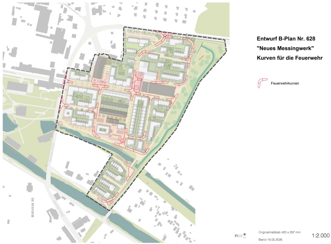
Abb. 11: Nachweis Schleppkurven für Rettungs- und Versorgungsfahrzeuge
