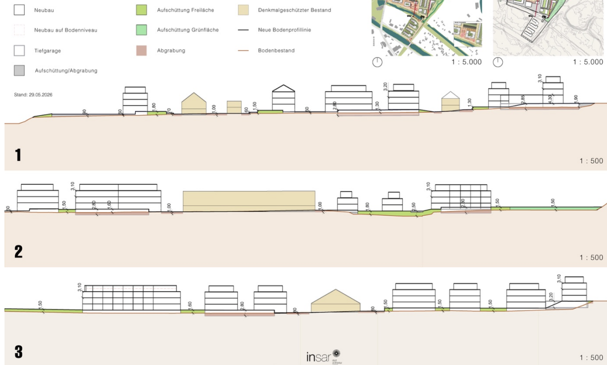
Abb. 15: Geländeschnitte Neues Messingwerk, Städtebauschritte zur Straßenraumplanung
