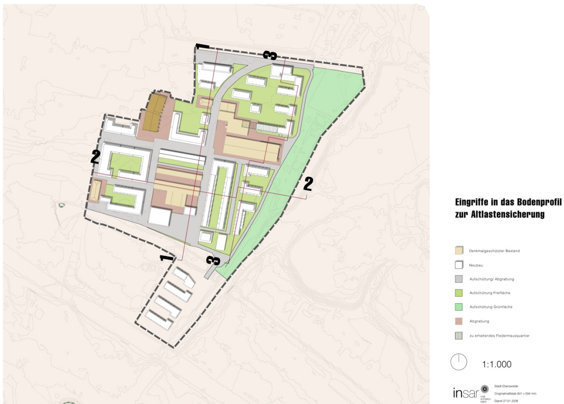
Abb. 12: Eingriffe in das Bodenprofil zur Altlastensicherung
